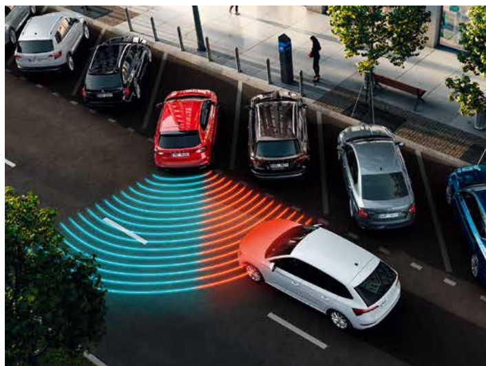
當偵測意外即將發生， RTA 後方車流警示系統立刻透過螢幕顯示圖像或聲音警示駕駛者，如有必要可主動煞停車輛。
