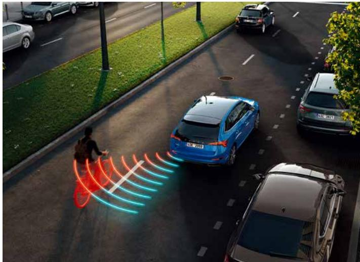
車側盲點警示系統可以透過感知器偵測最遠70公尺的車輛並給予駕駛警示，行駛於高速公路與雙線車道時格外受用。
