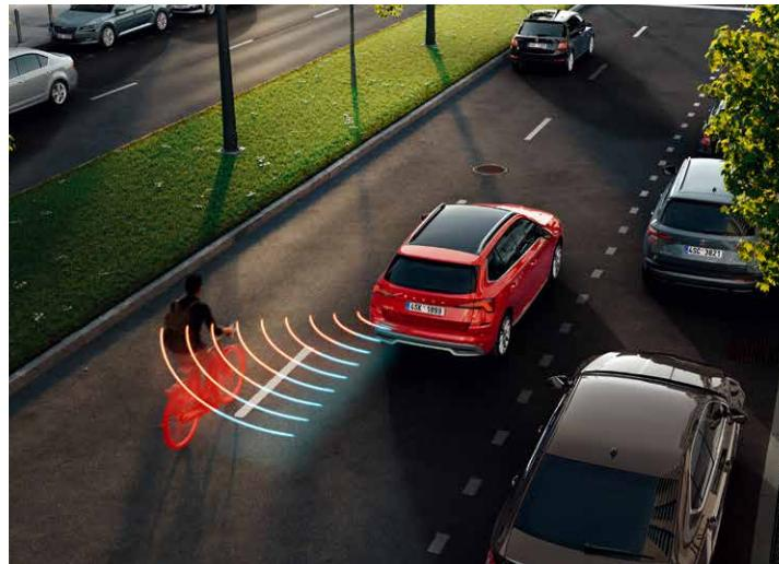
車側盲點警示系統可以透過感知器偵測最遠70公尺的車輛並給予駕駛警
